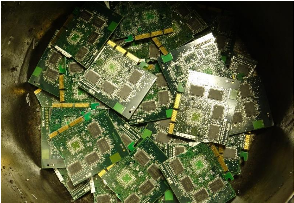
Abbildung 20: Positionierung der Leiterplattenhälften mit GPU im Zerkleinerungsbehälter (Quelle: IWKS 2020)
