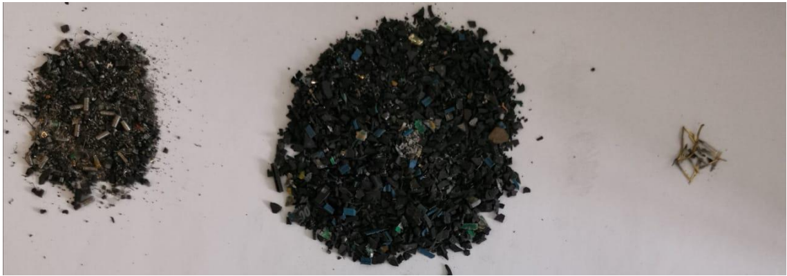
Abbildung 24: Ergebnis der Magnet- und Wirbelstromscheidung (Quelle: IWKS 2020).
