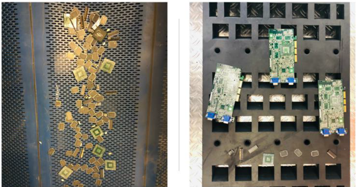
Abbildung 29: Größenvergleich der Komponenten und Leiterplatten auf der feinen und groben Siebstufe.
