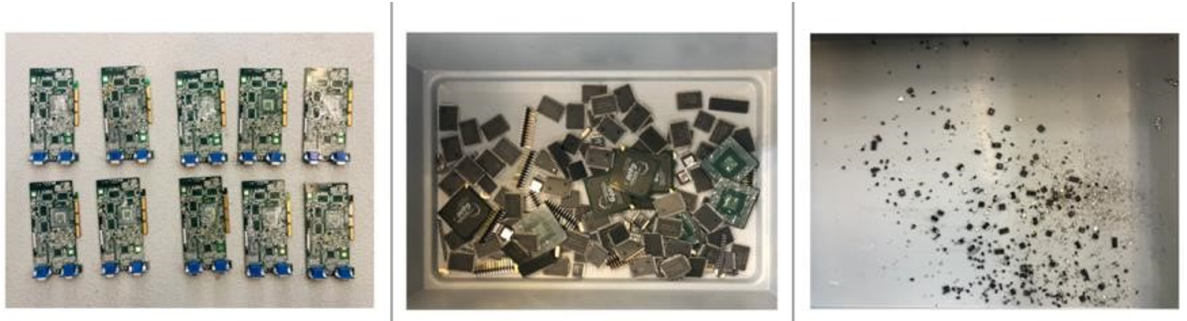
Abbildung 30: Ergebnis der Siebung (v.l.n.r.): Leiterplatten, Komponenten, Feinmaterial.
