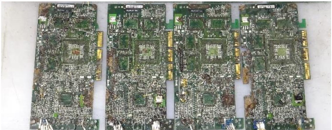
Abbildung 17: Vollständig entstückte Leiterplatten aus Versuch 1 (Quelle: IWKS 2020).
