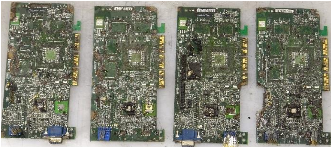
Abbildung 18: Unvollständig entstückte Leiterplatten aus Versuch 1 (Quelle: IWKS 2020).
