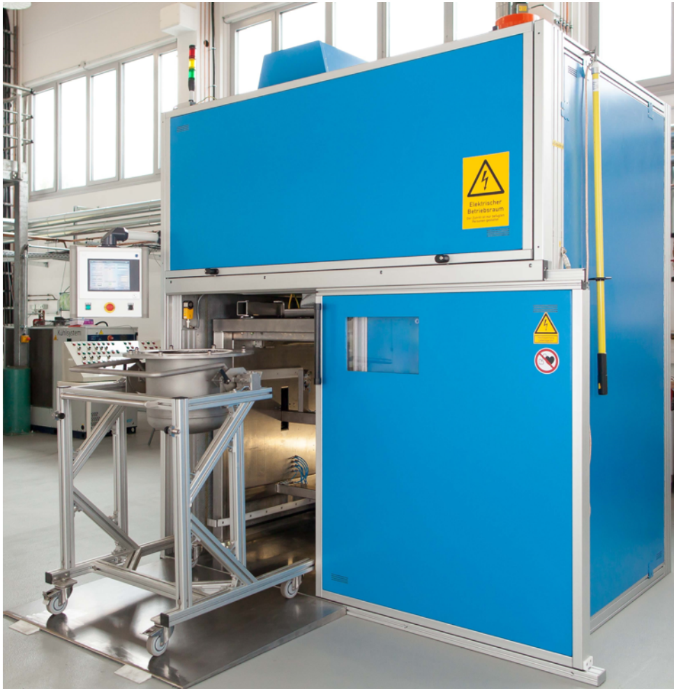
Abbildung 13: EHZ-Anlage im Technikumsmaßstab
