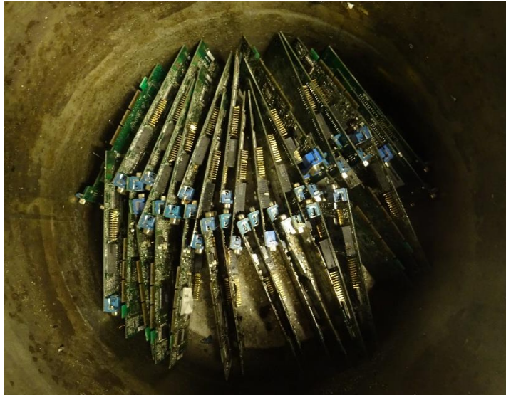
Abbildung 16: Positionierung der Leiterplatten im Reaktor bei Versuch 1 (Quelle: IWKS 2020).
