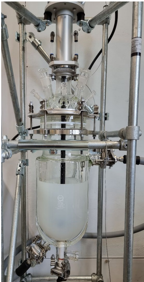
Abbildung 8: Rührkesselreaktor der Elutionsanlage mit einem Volumen von 5 Litern
