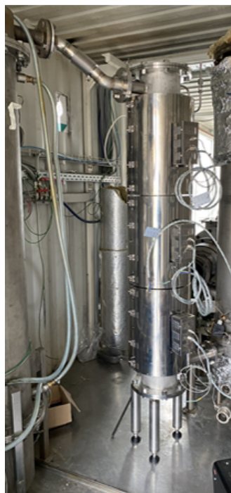
Abbildung 5: Chlorierungsreaktor während der Inbetriebnahme.
