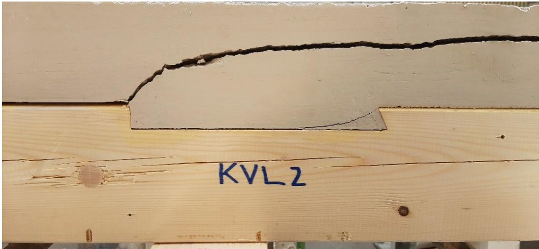
Abbildung 19: Bruchbild des unbewehrten CAF470-Betons
