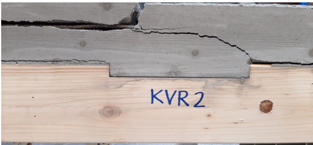
Abbildung 20: Bruchbild des bewehrten Referenzbetons OPC908
