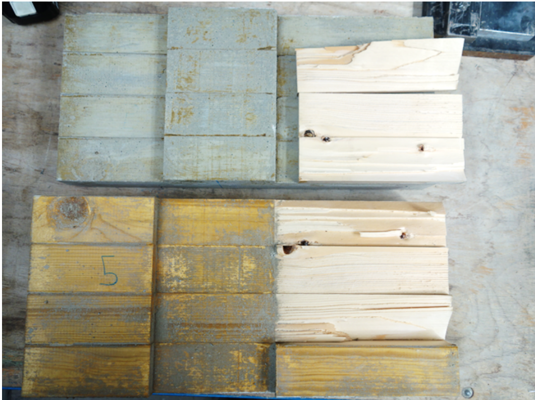
Abbildung 14: Schubversagen der Holzelemente im Vorholzbereich
