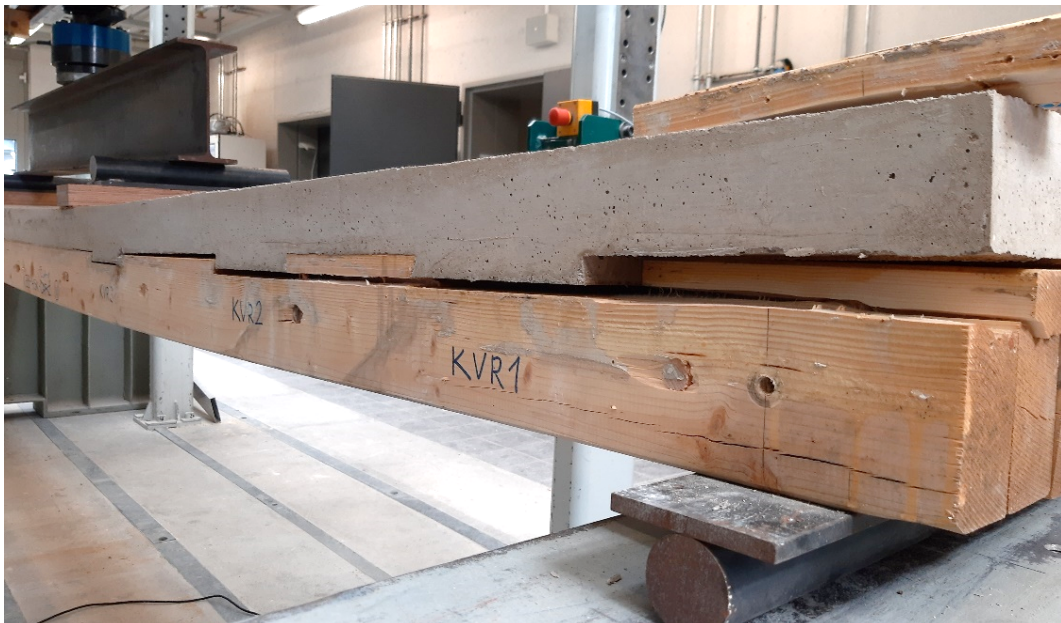
Abbildung 22: Holz-Abscheren der Kernen bei CSA906-Bauteil
