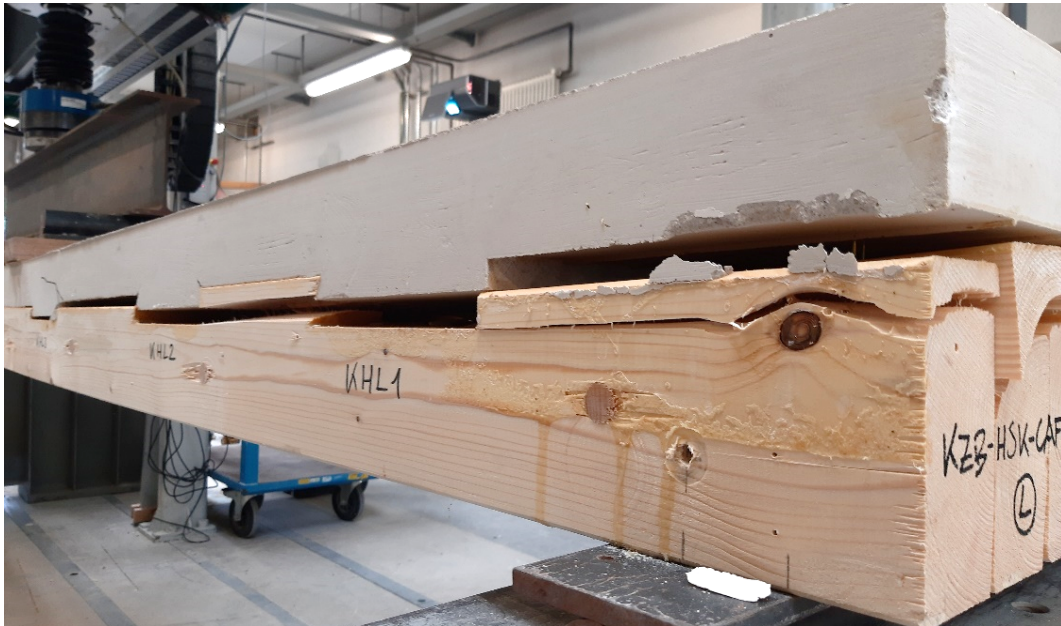
Abbildung 21: Holz-Abscheren der Kernen bei bewehrtem CAF470-Bauteil
