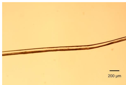
Abbildung 34: Oberflächenstruktur von Cellulose/Chitin-Hybridfasern, gesponnen bei 70°C und 7 bar aus einer Lösung bestehend aus 1 Gew.-% MCC, 0,5 Gew.-% Chitin, 20 Gew.-% BL und 78,5 Gew.-% BmimOAc. Neue funktionale Materialien
